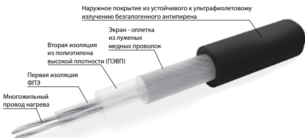
Конструкция нагревательного кабеля ELEKTRA TuffTec™
